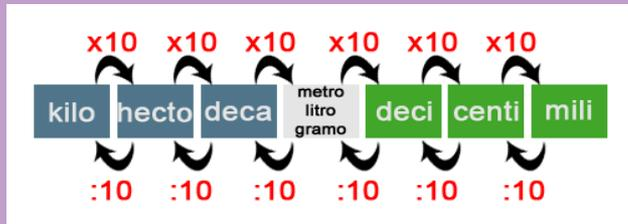
Para convertir a múltiplos se divide entre 10 por cada unidad que se recorre. Por ejemplo  $85 \text{ dm} = 8,5 \text{ m}$  ( $1 \text{ dm} = 0,1 \text{ m}$ )
